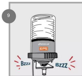
MEMOLUB® EPS MEMORY funciona imediatamente. NOTA: se não houver alteração nas configurações (toques) desde sua última operação, a unidade poderá não pulsar imediatamente.
