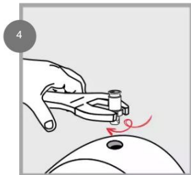
Aparafuse a conexão BSP 1/8 no ponto de lubrificação.
