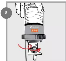
Instale MEMOLUB® EPS MEMÓRIA no Memo. Conecte o cabo à fonte de alimentação de 24 Vcc.
